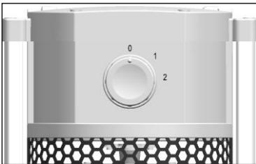
Apăsând butonul de operare la poziția I (450W, jumătate din capacitate) sau II (900W, întreaga capacitate), puneți aparatul în funcțiune. Pentru a opri aparatul, setați butonul la poziția 0 și scoateți ștecherul din priză. Lăsați radiatorul să se răcească.
